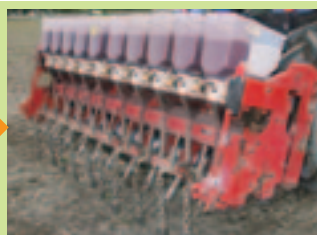
V字直播機での播種模様。 10個のホッパーにコーティング種籾が入っています。
